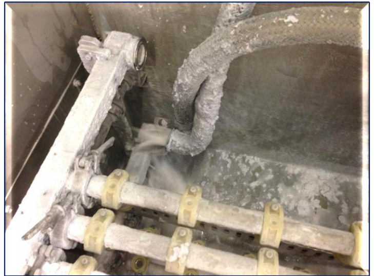
Lúgos lerakódás kimosása nagynyomású tisztító berendezésből.
