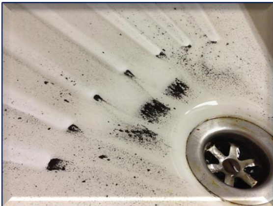
Radiátoros körből kimosott fémszilánkok.
