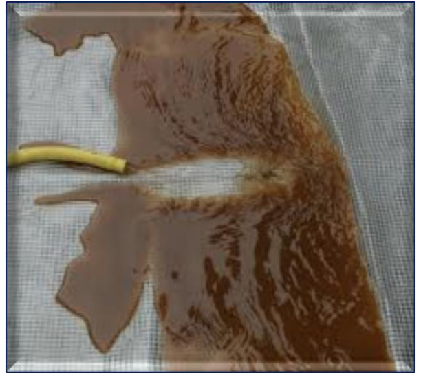
Padlófűtési rendszerből kimosott iszap.
